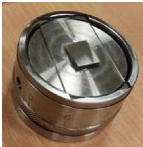
Rysunek 4. Uchwyt do cienkich szlifów STRUERS z mocowaniem w gnieździe szkiełek laboratoryjnych z naklejoną płytką stalową ( podłoże do pokrywania)
