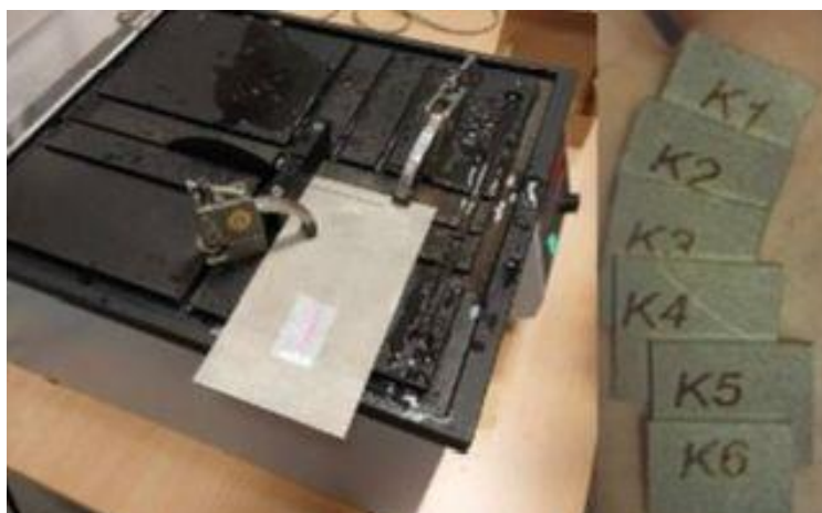
Rysunek 2. Przecinarka tarczowa CT2300 i próbki po cięciu
